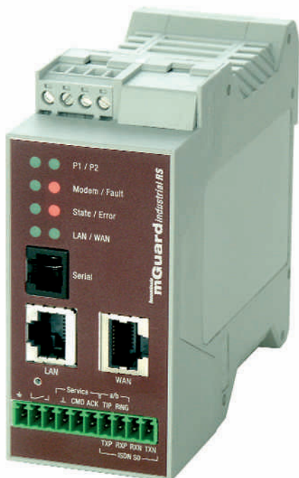
Bild 2: Für die Absicherung von Automatisierungstechnik im Schaltschrank werden Hut-schienengeräte wie der mGuard industrial RS bevorzugt.
