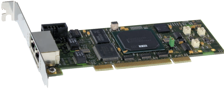
Bild 4: Für PC-basierte Bedien-Panels oder Steuerungen eignen sich Appliances im PCI-Kartenformat.
